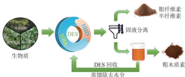
图 3 低共熔溶剂法分离木质纤维生物质组分
