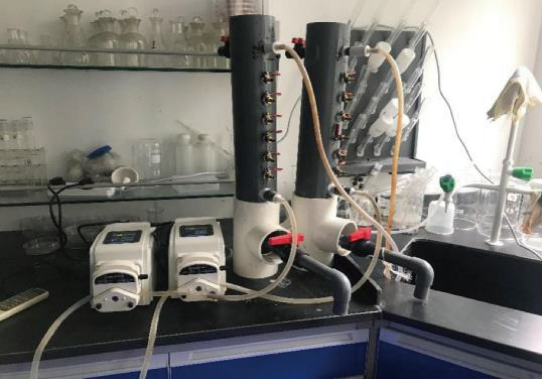
图2 生物过滤装置
