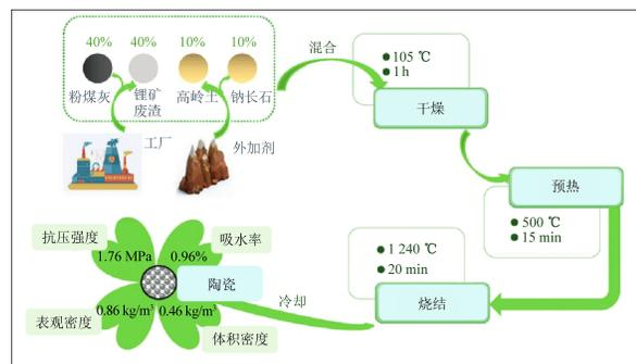
图 6 锂矿废渣与粉煤灰协同制备轻质陶粒<sup>[13]</sup>
