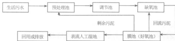
图3 MBR/表流人工湿地处理工艺流程
