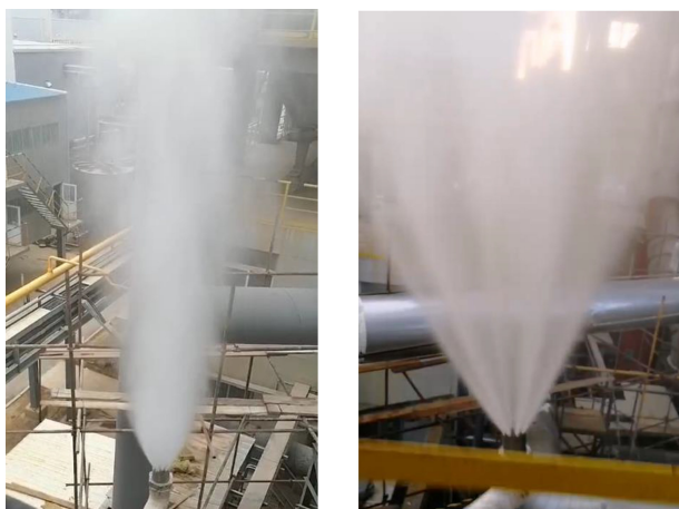
(a) 喷枪更换喷头前 (b) 喷枪更换喷头后
